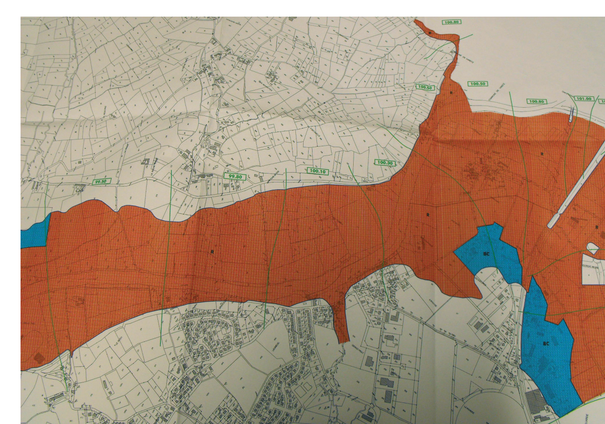
Extrait d'un plan de prévention du risque inondation. La zone rouge est inconstructible
