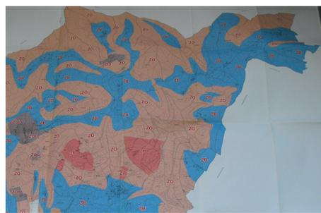
Extrait du plan de zonage du plan de prévention du risque mouvement de terrain de Noailhac. Les zones rouges sont les plus vulnérables et celles où il y a le plus de contraintes.
